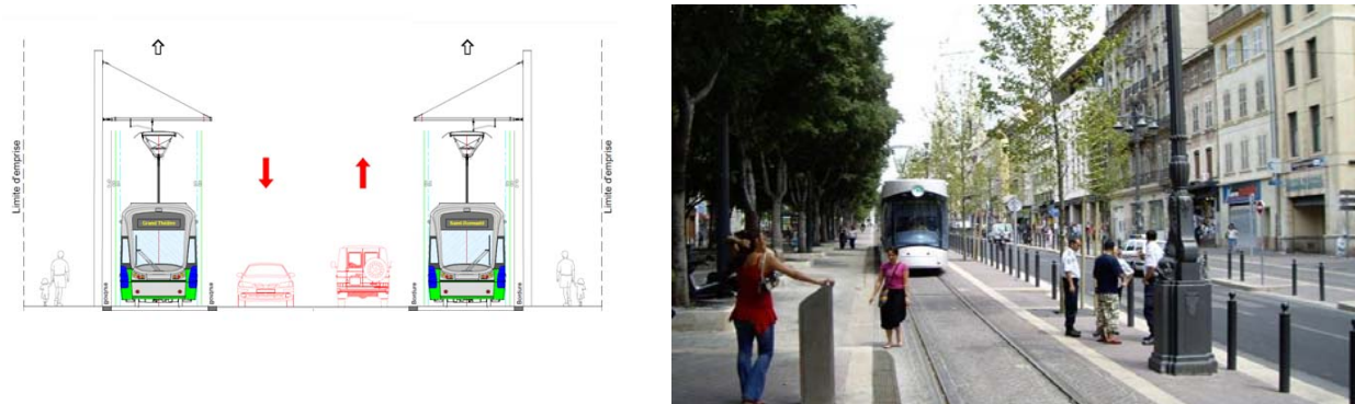
Figure 6 : Coupe-type et illustration d'un tramway en position bilatérale
